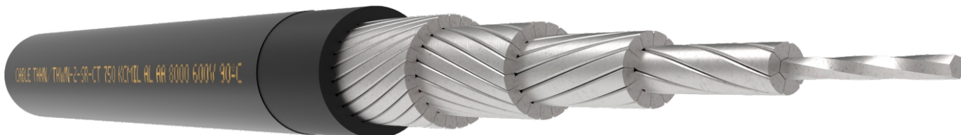
CABLE THHN/THWN-2-SR-CT 750 KCMIL AL AA 8000 600V 90°C
